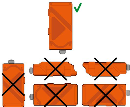
Fijar la Unidad receptora en cuatro puntos utilizando los orificios predisuestos en la cubierta. No perforar en ningún caso la Unidad receptora.
